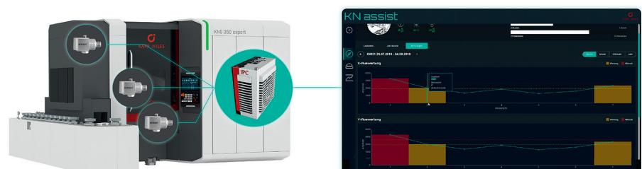
**5** Zur Überwachung der Achsen wird analog zum Process Monitoring System die Maschine mit zusätzlicher Sensorik und einem leistungsstarken IPC zur Auswertung der aufgenommenen Daten ausgestattet © Kapp Niles
