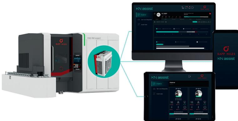
**3** Mit dem Kapp Niles Production Monitoring System lassen sich alle angeschlossenen Maschinen in einem Dashboard darstellen; zwei Anzeigen sind wählbar © Kapp Niles
